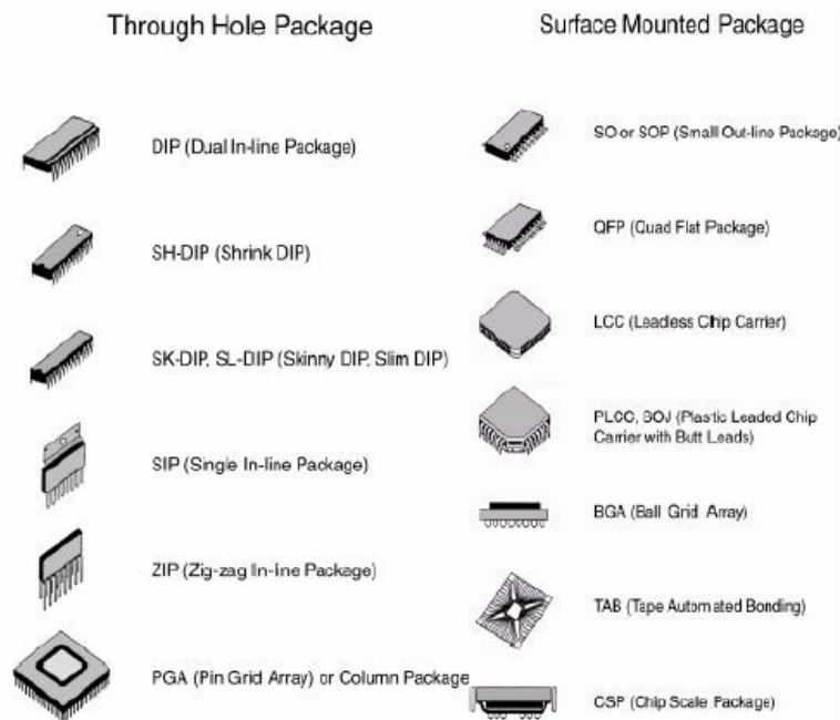
Σχήμα 9 Τύποι συσκευασίας διατάξεων (Component package types)
